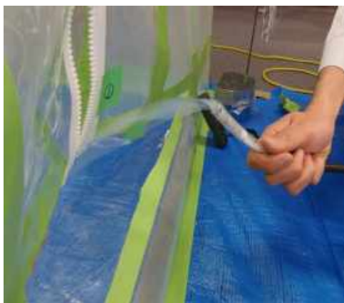
図 4.14.10 スモークテスターによる確認
