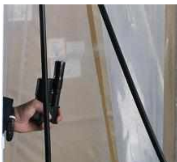
図4.14.9 セキュリティゾーンの入口の気流方向の確認
