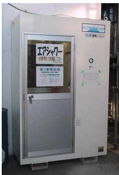
写真III-4 エアシャワールーム（2重扉）の例
