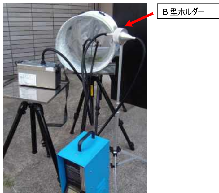
図4.14.19 排気ダクト内からのPCM法サンプル採取例
