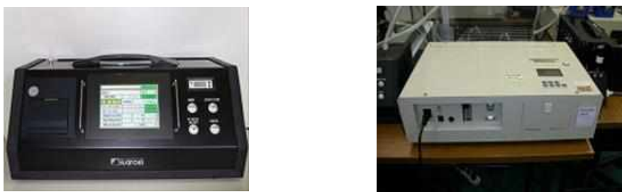
図4.14.4 繊維状粒子自動計測器の例（2）
