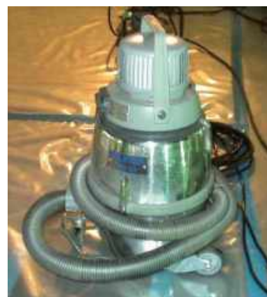
図 4.7.61 高性能真空掃除機
