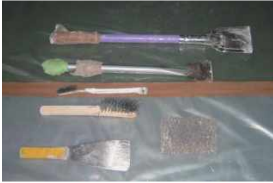
図 4.7.58 除去作業用の手工具の例
