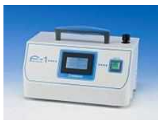
図4.14.4 繊維状粒子自動計測器の例（1）
